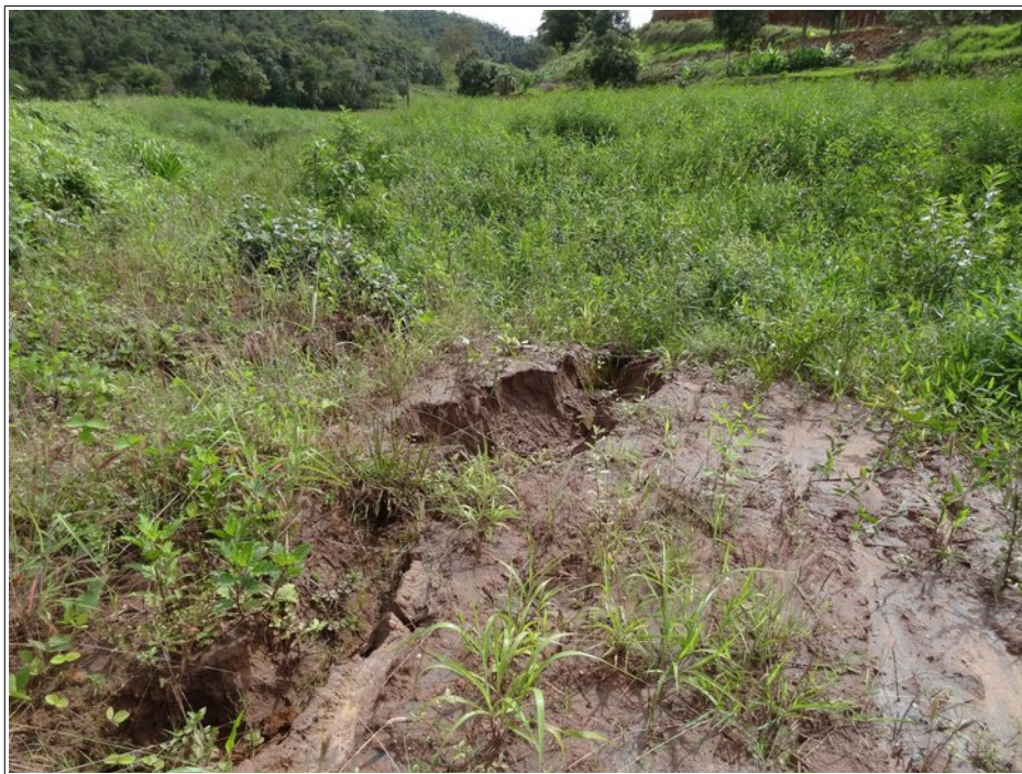
ITG 35 c: Detalhes de ravinamento severo em camada de rejeito exposta, montante do tributário.
