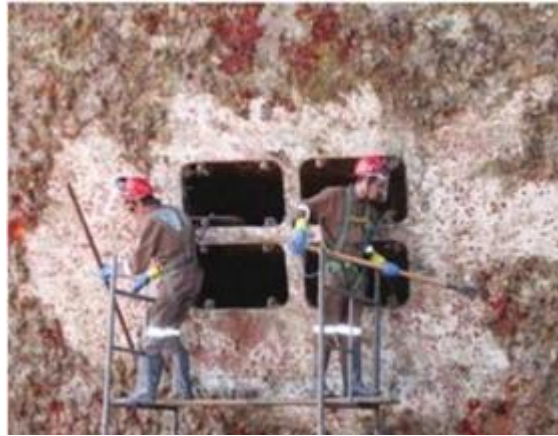
Figura 4 – Remoção manual em embarcação mantida em dique-seco.
