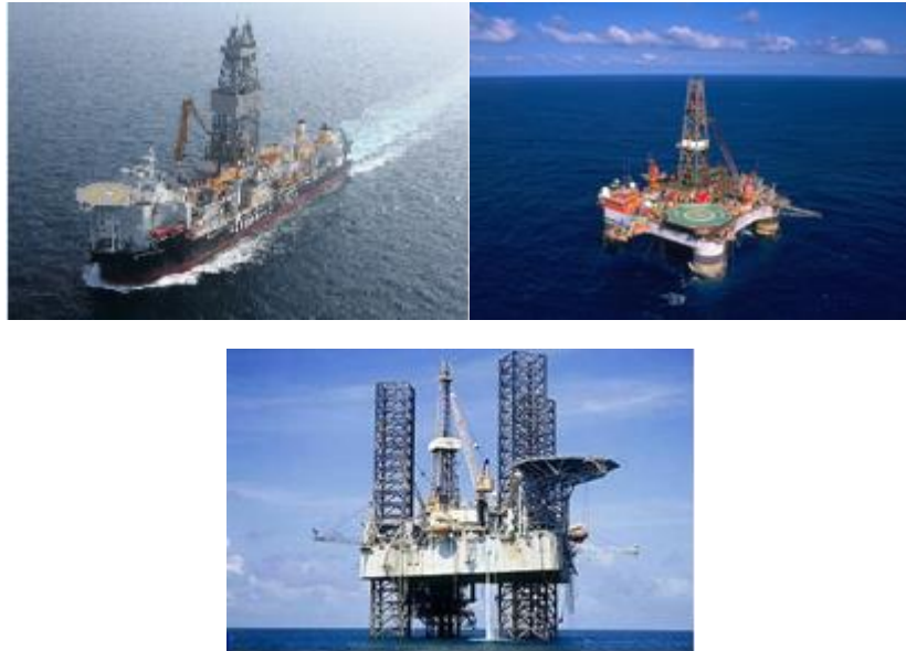
Figura 11. Exemplos de tipos de sondas: Navio-Sonda, Semi-Submersíveis e Auto-elevatórias.
