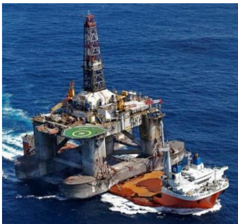
Figura 6a – Uma sonda semi-submersível sendo transportada por um HLV (MAF, 2009).
